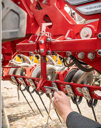
Striegel hinter Traktorrädern: Handhabung und Arbeitsbild gut, Stabilität fragwürdig.
