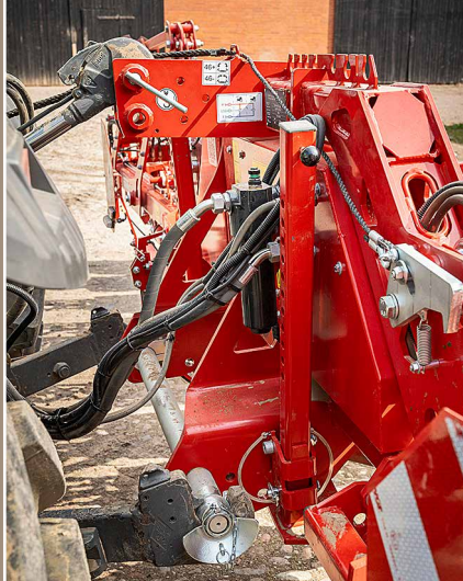
Der Anbauraum ist aufgeräumt. Schön: Abstellstützen sind immer an Bord.
