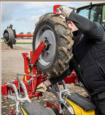
Die Stützräder lassen sich einfach hochschwenken – eine nützliche Funktion.
