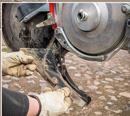
Eine Schraube lösen, die andere herausdrehen: Danach ist der Schar-tausch möglich – top.
