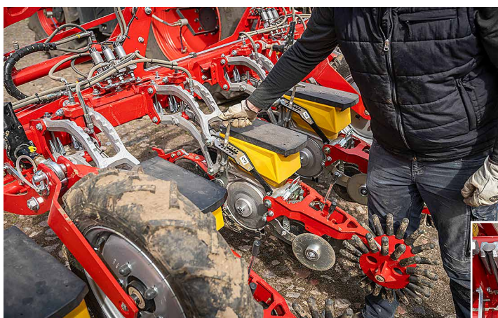
Mit einem Schlagschrauber sind Tasträder und Schneidschneiden schnell demon- tiert.
