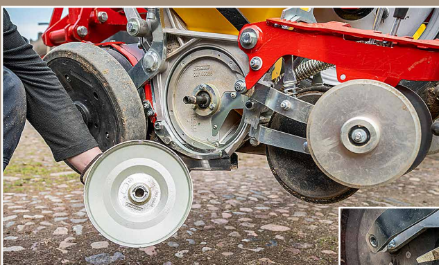
Das Säherz ist unverändert, mittlerweile sind für Rüben jedoch Zellenräder mit acht Kammern Serie.
