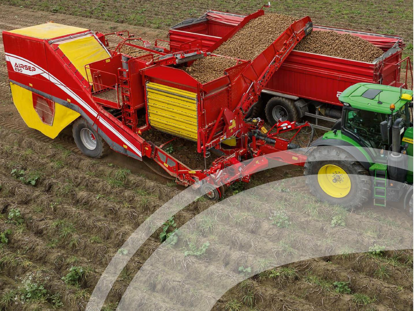
AIRSEP 290 — это двухрядный уборочный комбайн с бункером с полностью гидравлическим приводом, запатентованным сепарирующим устройством AirSep и емкостью бункера в серийном исполнении 9 т.
