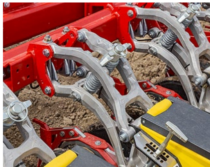
Neues Parallelogramm: Die Federverstellung mit fünf Positionen wirkt sehr solide.
