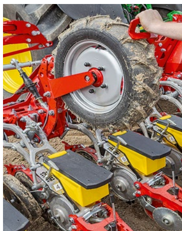
Nach Lösen einer Schraube lässt sich das Schar von der Aufnahme ziehen.
