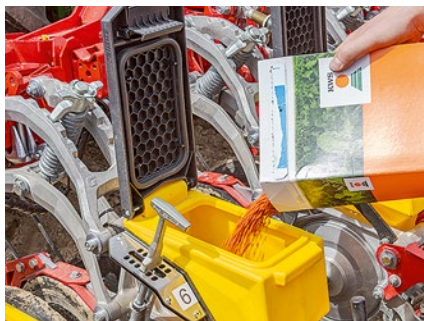
Die Öffnung ist kleiner als zuvor. Das Saatgut lässt sich trotzdem gut einfüllen.
