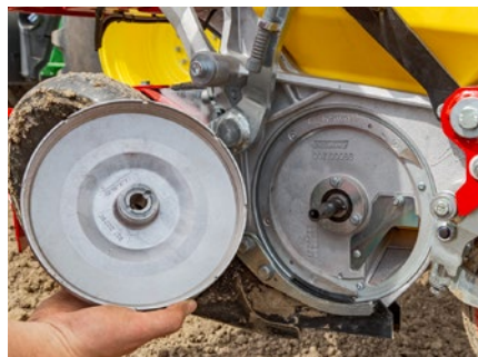
Das Vereinzelungsprinzip ist bewährt. Neu ist das serienmäßige R8-Zellenrad.
