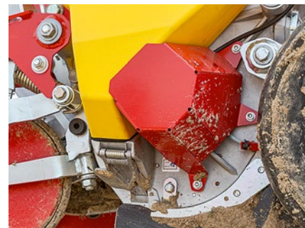
Die Klappe zur Restentleerung und die Motorabdeckung wurden leicht verändert.
