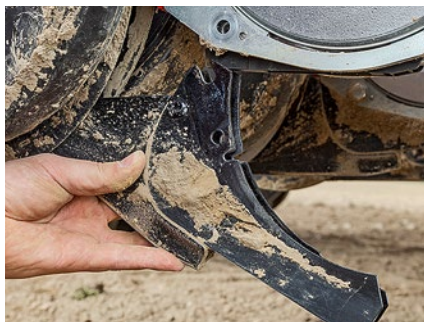
Nach Lösen einer Schraube lässt sich das Schar von der Aufnahme ziehen.
