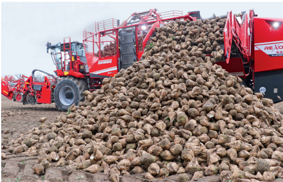
Der REXOR entlädt die 45 m³ Rüben in rund einer Minute und formt eine bis zu 4 m hohe Miete.
