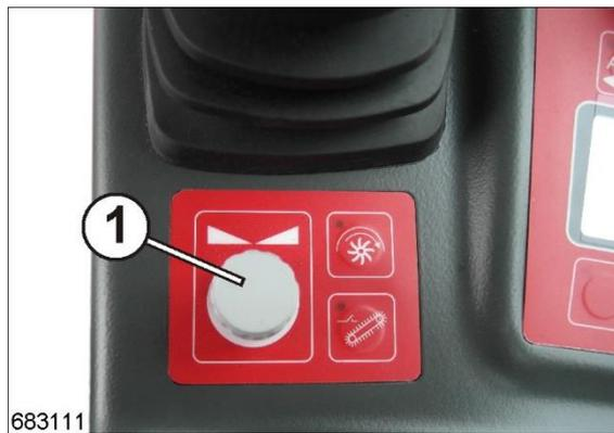
Über den Drehregler (1) können die Räder der Hinterachse ausgelenkt werden. Diese Funktion wird beim Roden von engen Kurven genutzt. So wird die Maschine in einem bestimmten Radius gelenkt und es können mit dem Autopilot enge Kurven gerodet werden.
