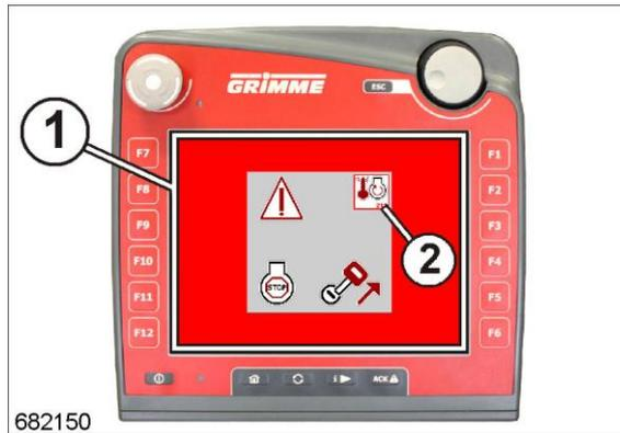
➔ Sobald auf dem Bedienterminal die rote Warnmeldungsanzeige (1) erscheint, befindet sich die Maschine in einem kritischen Betriebszustand.
