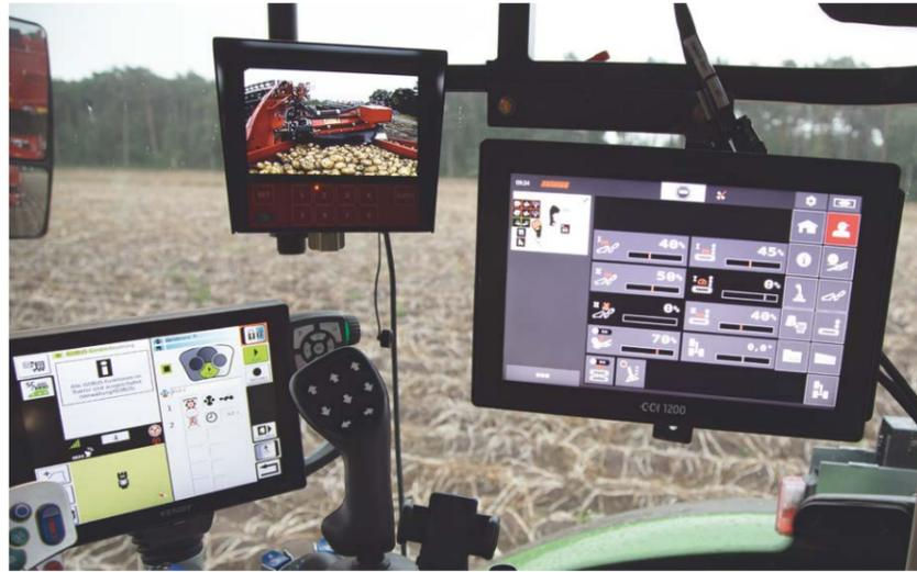
Speedtronic es el control automático de velocidad en función de la carga para el 1er y 2º separador y también para la cinta de clasificación. El conductor es liberado de tareas de ajuste manuales, el peligro de obstrucción se reduce al mínimo y se logra un máximo cuidado del producto.
