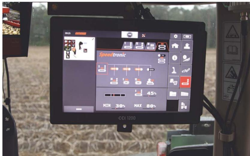
Con MemoryControl es posible el ajuste central de los accionamientos y separadores. Parámetros de ajuste, tales como velocidades de giro, ángulos de ajuste y valores límite se pueden almacenar para diferentes condiciones de cosecha y se pueden recuperar rápidamente pulsando un botón. De este modo, se pueden memorizar hasta 8 programas para poder pasar de un modo cuidadoso a otro orientado al rendimiento.
