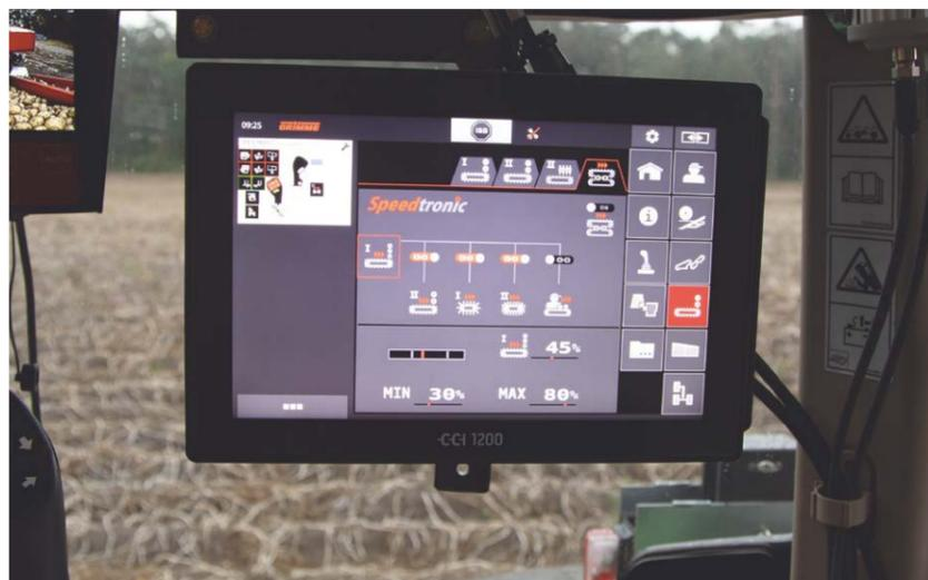
Le réglage central de l'entraînement et des séparateurs est rendu possible grâce au MemoryControl. Les paramètres de réglage comme par exemple les vitesses de rotation, l'angle de réglage et les valeurs limites, peuvent être enregistrés pour les différentes conditions d'arrachage et en fonction de la situation être rapidement mis en place par l'appui sur un bouton.
