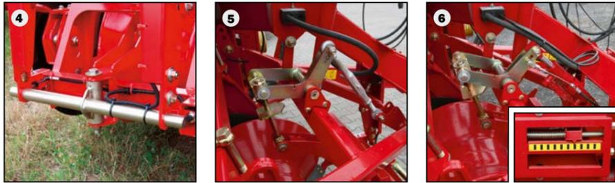
Fácil solución: Ajuste la profundidad de arranque mediante el husillo de ajuste (5) u opcionalmente con accionamiento hidráulico continuo (6) desde el asiento del conductor del tractor.
