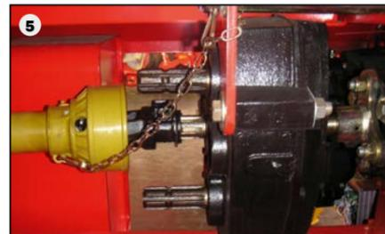
El accionamiento libre de mantenimiento de la segunda cinta de criba y de la cadena de broza de malla ancha (4) con un árbol de transmisión, garantizan un funcionamiento suave de la máquina.
