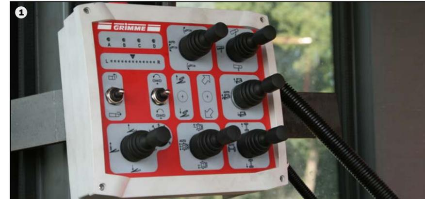
De la práctica, para la práctica: la toma lateral por el lado derecho del conductor se corresponde con la ergonomía de la cabina del conductor, garantizando el fácil manejo de la máquina. Todas las funciones importantes de la máquina, como el ajuste opcional de la profundidad de rejas y alivio de los caballos hidráulico, son fáciles de controlar desde el asiento del conductor (1).
