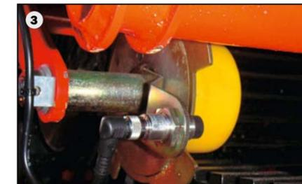
Reacción rápida a los fallos: con el control de deslizamiento opcional de la segunda cinta de criba (3) y del primer dispositivo separador.
