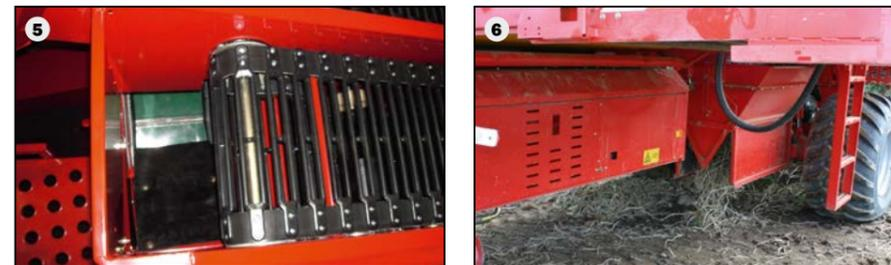
La caja de piedras opcional (6) tiene una capacidad de aprox. 500 kg. El llenado se efectúa mediante canales de entrada dispuestos óptimamente; el vaciado es mecánico mediante un pedal en la estación de selección. Opcionalmente incluye sistema de vaciado hidráulico desde el asiento del conductor en el tractor.
