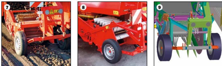
Toma de gavilla mediante una reja de palas: compuesta de ruedas de apoyo, ajuste hidráulico de la profundidad y especialmente diseñada para tipos de suelos muy livianos.
