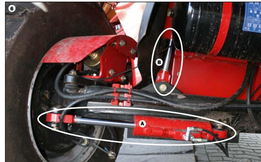
Dirección de eje hidráulico: Una opción que parece ser sobrentendida: La dirección de eje hidráulica garantiza una maniobrabilidad elevada y un manejo rápido (6A).
