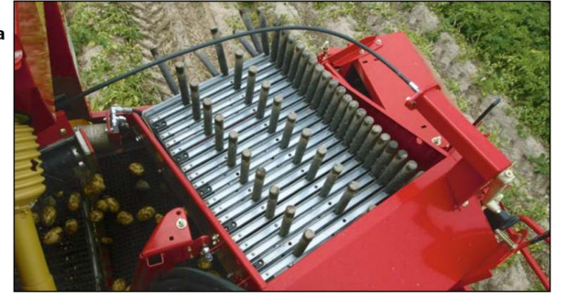
La velocidad de la cinta de dedos se puede regular hidráulicamente de forma continua.
