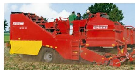
SE150/170-60: cosechadora de patatas lateral de dos surcos, absolutamente potente, robusta y segura, con tolva grande para 6000, 7000 y 7500kg
