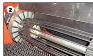
Niveles de caída mínimos, máximo cuidado de la cosecha: gracias a la reducción del nivel de caída de la primera a la segunda cinta de criba (1). Se hace posible por la entrada ubicada en plano casi horizontal. El escaso nivel de caída desde la segunda cinta de criba hacia el primer dispositivo separador (2) también protegen el producto, al igual que las varillas móviles de la cinta de criba, que, además, limpian las paredes laterales del canal.
