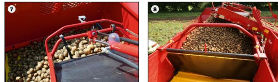
Niveles de caída mínimos para el llenado de la tolva de fondo móvil (7/8) mediante la elevación y el descenso hidráulico de la cinta previa. Beneficiarse de la cinta previa automática (opción): Si sube el cono acumulado en la tolva, se eleva la cinta previa automáticamente a pasos pequeños, para alcanzar un nivel de caída bajo y uniforme.
