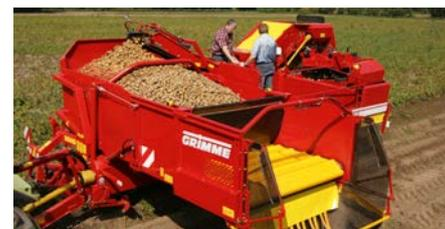
SE75/85-55: cosechadora de patatas lateral de un surco, con tolva grande de 5.500kg – la máquina idónea para los que buscan el rendimiento de roturado entre las máquinas de uno y dos surcos
