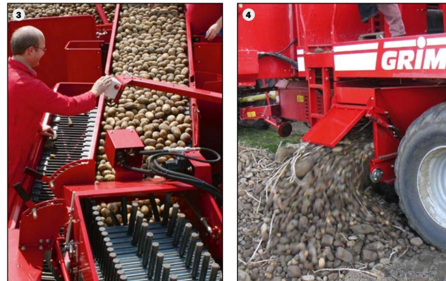
Mesa de selección con superficie casi plana: Hasta 6 personas pueden trabajar en la cinta clasificadora (3) con una práctica cinta de desperdicios (5). El accionamiento hidráulico con ajuste continuo de velocidad (opción) permite la sintonización óptima para el volumen de cosecha y para la cantidad de desperdicios. El personal de selección puede transmitir una señal de aviso a la cabina de conductor, mediante la presión de un botón. Opcionalmente incluye dos planos inclinados.
