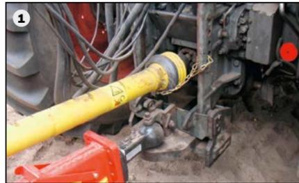
Como alternativa la máquina es acoplada con seguridad debajo de la conexión de toma de fuerza. Todas las argollas son regulables en altura para la adaptación a diferentes vehículos tractor (1).
