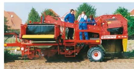
SE75-20: para extensiones pequeñas a medianas, construcción especialmente compacta (baja), tolva de fondo móvil para 2000 a 2300 kg
