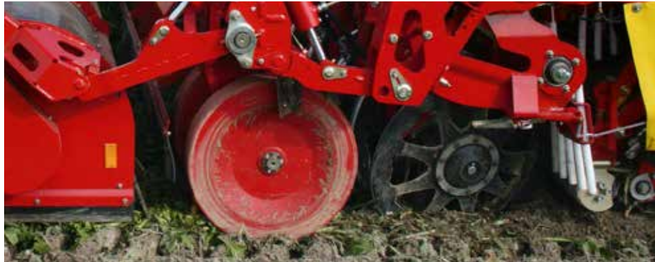
Hidrolik tahrikli ve yanal hareketli, ( \pm 40 mm) sarkaçlı, tekerlekli sökme pullukları, şaşırtmalı sıralarda da pancarların optimal alımını sağlar
