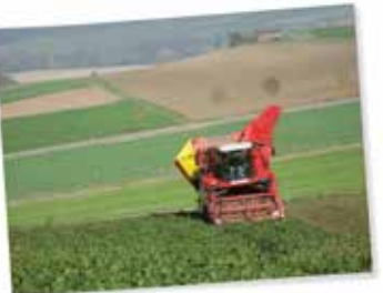
İsviçre'nin yamaçlarında MAXTRON 620, şev dengelemesi sayesinde şeritte kalıyor.
