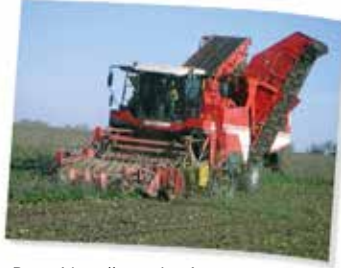
Rusya'da yoğun yabani ot gelişimi: Yan atma duvarlı yaprak kıyıcı ile rotorlu baş kesiciden oluşan kombinasyon için hiç sorun değil
