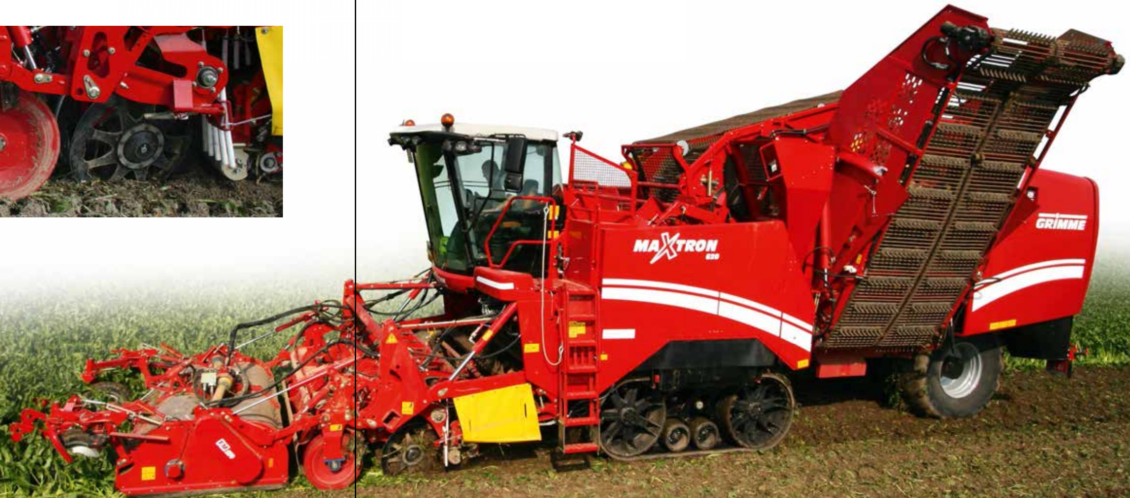
Hidrolik tahrikli ve yanal hareketli, ( \pm 40 mm) sarkaçlı, tekerlekli sökme pullukları, şaşırtmalı sıralarda da pancarların optimal alımını sağlar
