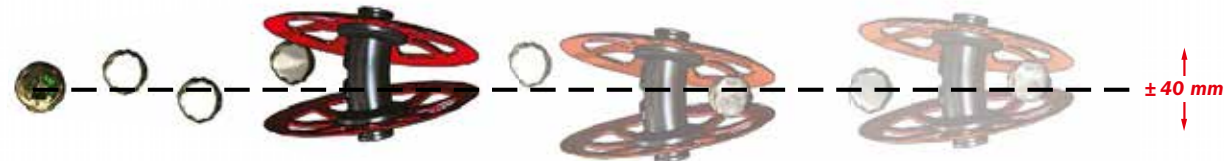
Hidrolik tahrikli ve yanal hareketli, ( \pm 40 mm) sarkaçlı, tekerlekli sökme pullukları, şaşırtmalı sıralarda da pancarların optimal alımını sağlar
