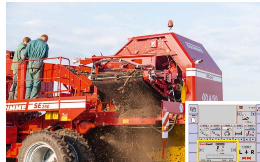
Speedtronic es el ajuste de revoluciones automático dependiente de carga para el 1er y 2º separador y también para la cinta de clasificación. El conductor es liberado totalmente de las tareas de ajuste manuales, y se reduce al mínimo el peligro de obstrucción y se logra un máximo cuidado del producto.
