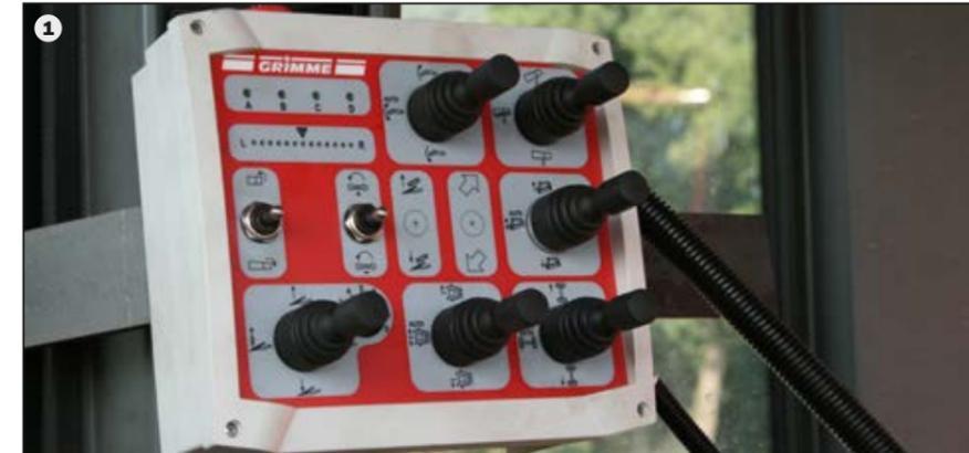
De la pratique pour la pratique : l'arrachage latéral sur le côté droit de la cabine correspond à l'ergonomie de la cabine du conducteur et assure une manipulation simple de la machine. Toutes les fonctions décisives de la machine, ainsi que le réglage hydraulique de la profondeur des socs et le dispositif automatique de soulagement sur buttes en option peuvent être confortablement pilotées à partir de la cabine (1).
