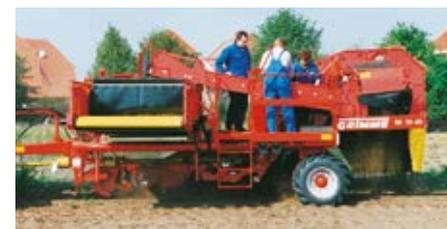
SE 75-20: pour petites à moyennes surfaces, construction particulièrement compacte (basse), trémie à fond mouvant pour 2000 ou 2300 kg
