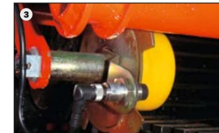
Réaction plus rapide face à des perturbations : grâce au contrôle optionnel du patinage de la 2<sup>e</sup> chaîne de tamisage (3) et du 1<sup>er</sup> séparateur
