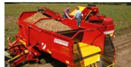
SE 75/85-55: arracheuse de pommes de terre 1 rang, déportée avec grande trémie de 5500 kg – la solution idéale pour tous ceux recherchant des performances d'arrachage entre des machines à 1 et 2 rangs
