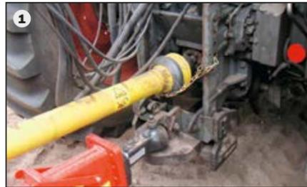
En alternative, la machine est assurément attelée en-dessous du raccord de la prise de force. Tous les anneaux de timon sont réglables en hauteur pour permettre une adaptation à n'importe quel tracteur (1).
