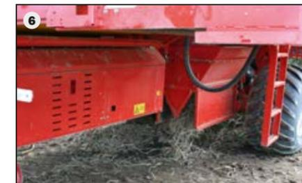
Le bac à cailloux « long » (6) optionnel a une capacité d'env. 500 kg, son remplissage s'effectue par les goulottes de déversement et sa vidange de façon mécanique, à l'aide d'une pédale sur le poste de triage. Vidange hydraulique à partir de la cabine possible en option.
