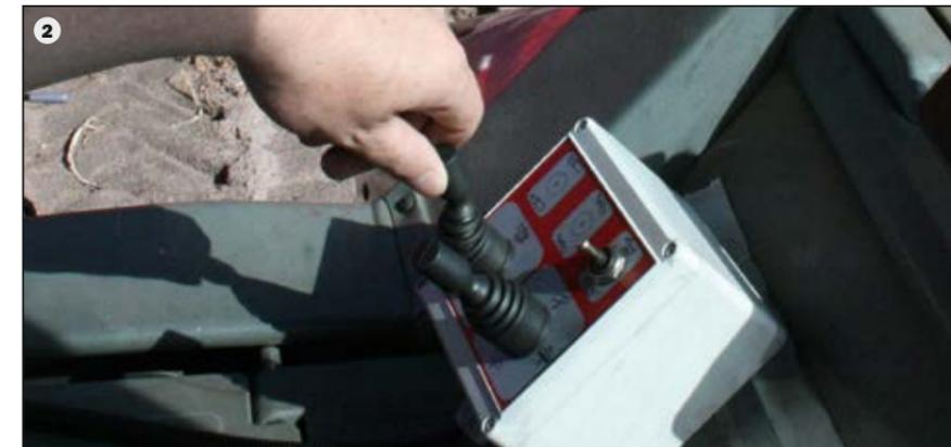
Un boîtier supplémentaire pratique (2) est monté en série sur le côté gauche pour faciliter le déchargement de la trémie.
