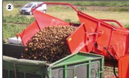
Pour ceux qui ont beaucoup à faire : La trémie largement dimensionnée (3) a une capacité de 4.000 kg et peut être facilement levée par la pression d'un bouton pour assurer le déversement.
