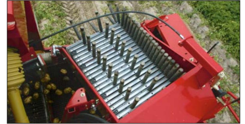
Réglage de vitesse hydraulique progressif de la bande à doigts.
