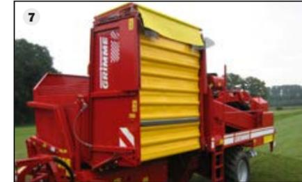
Sortie amortie grâce à la bêche de déversement (option) (6) pour un remplissage en douceur des camions de transport
