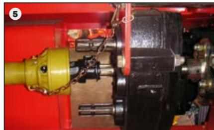
L'entraînement sans entretien de la 2<sup>e</sup> chaîne de tamisage et de la chaîne effaneuse grandes mailles (4) avec arbre à cardan assure la régularité du fonctionnement de la machine.
