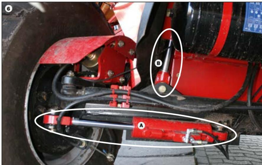
Braquage hydraulique des roues : Une option presque évidente : le braquage hydraulique des roues assure une grande maniabilité et des manœuvres de braquage rapides (6 A).
