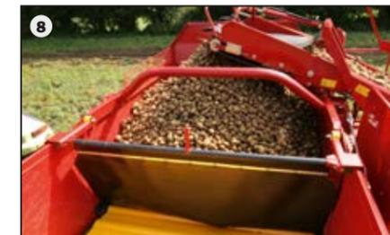
Hauteurs de chute minimales lors du remplissage de la trémie à fond mouvant (7/8) grâce au soulèvement et à l'abaissement du tapis col de cygne. Profitez de l'automatisme du col de cygne (option), qui se lève au fur et à mesure du remplissage de la trémie, pour maintenir une hauteur de chute constamment minime.
