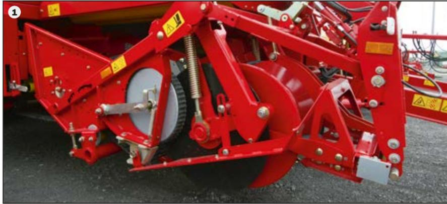
Bon ramassage : réglez l'angle de positionnement des socs et la profondeur d'arrachage idéale – choisissez le soc 2-parties pour des terrains lourds ou le soc 3-parties pour les sols moyens et légers (2). Pour plus de sécurité, protégez les socs à l'aide de la sécurité anti-pierres en option.
