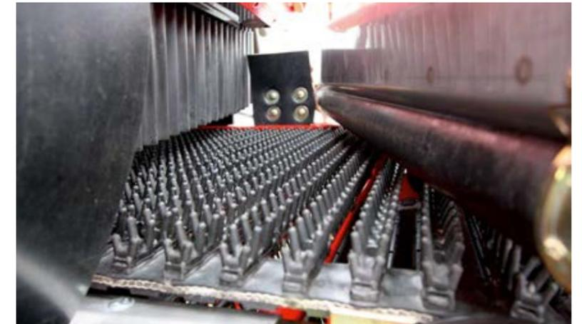
Der Walzenabstreifer sorgt abschließend für eine verlustfreie Trennung von Kartoffeln und Beimengen.
