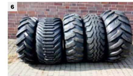
Die SE 75-20 kann mit fünf verschiedenen Reifen unterschiedlicher Dimensionen ausgestattet werden (6). So steht für alle Bedingungen die passende Bereifung zur Verfügung.
