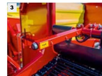
Alle entscheidenden Maschinenfunktionen, wie auch die optionale Dammdruckregelung, sind bequem über die Hauptbedienbox zu steuern (1). Für das komfortable Abbunkern ist serienmäßig linksseitig eine praktische Zusatzbedienbox montiert (2). Die Maschinenfunktionen lassen sich direkt vom Verlesetisch bedienen. Der Fahrer kann gegebenenfalls mit einer Hupe gewarnt bzw. informiert werden (3).
