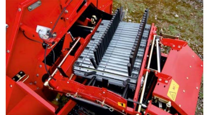
Die Geschwindigkeit des Fingerbandes ist stufenlos hydraulisch verstellbar.
