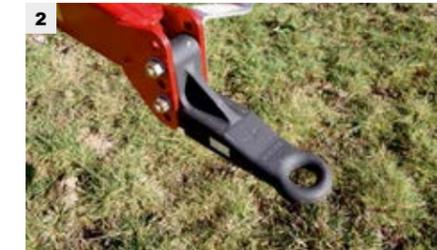
Bei der Anhängung kann zwischen Zugmaulanhängung (1) und Hitch (2) ausgewählt werden. Außerdem kann gewählt werden, ob der Zapfwellenanschluss über (3) oder unter der Anhängung liegen soll.
