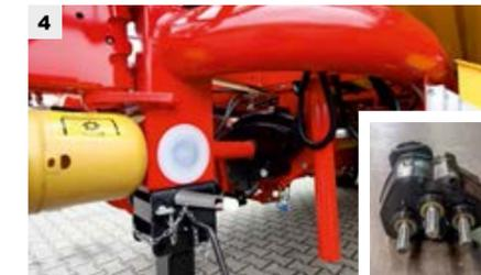
Dreistufen Getriebe (Option) (4): Sämtliche mechanisch angetriebene Einheiten können einfach in der Geschwindigkeit reduziert werden, um die Maschine auf empfindliches Erntegut abzustimmen.
