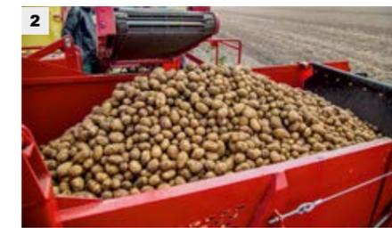
Der Rollbodenbunker (1) fasst 2000 kg und verfügt mit einer Auslaufhöhe von maximal 3,30 m durch die Parallelogramm-Aufhängung über nahezu gleichbleibende Überladeweiten.
