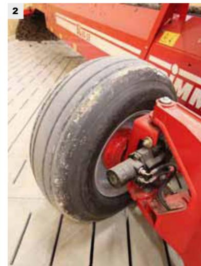
(2) Гидравлический привод колес, не требующий техобслуживания, дает возможность бесступенчатой регулировки поворота без препятствующих колебательных движений. Ведущие колеса с независимым друг от друга приводом обеспечивают маневренность машины даже в ограниченных пространствах.
