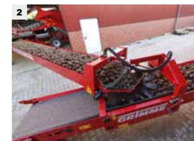
(2) Бесступенчатая регулировка длины дает возможность подсоединения телескопического ленточного погрузчика без переоборудования всей линии.
