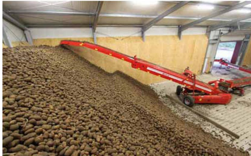
(1) Большая прорезиненная загрузочная воронка гарантирует бережное отношение к продукту, а транспортная лента обладает очень высокой транспортировочной способностью, которая усиливается за счет V-образных захватывающих элементов и двигающихся параллельно с транспортером боковых стен.
