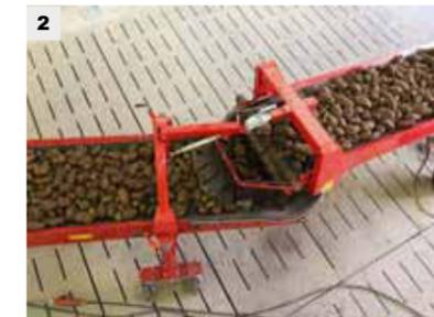
(2) Сцепное устройство, соединяющее транспортер и ленточный погрузчик, обеспечивает беспрепятственное передвижение последнего в процессе работы.
