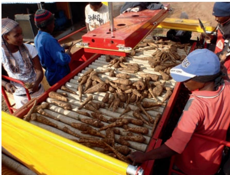
(1) / (2) La combinación de tolva receptora y clasificación detrás de ella es una unidad contundente y al mismo tiempo flexible. Según sean los requisitos de exactitud de clasificación y cuidado del producto se puede combinar la Combi con una clasificadora de malla o con una unidad de rodillos de uno u dos niveles.
