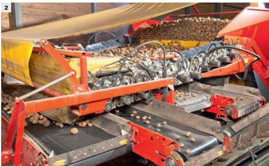
(2) Con la RH 20 / RH 24 se puede desterrar y fraccionar en un solo trabajo. Con ayuda de una o dos unidades fraccionadoras conmutadas consecutivamente se pueden generar así hasta tres fracciones.
