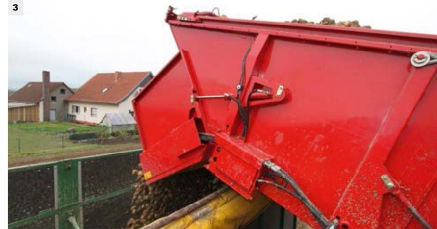
Fallstufenoptimierte Übergabe: Auf Wunsch kann der Rollbodenbunker mit einer Bunkerkopfabsenkung ausgestattet werden (3).
