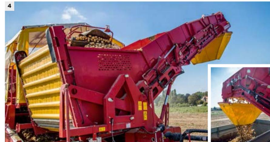
Überladebunker mit einem durchgängigen Bunkerband für echtes Non-Stop-Roden (4).
