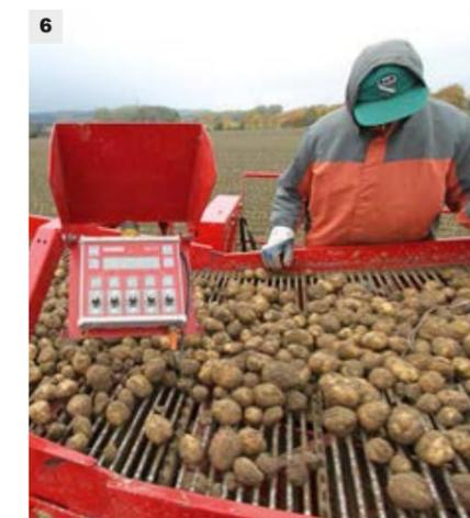
Zum Abbunkern auf der linken Maschinenseite können zwei zusätzliche GBX-Bedienboxen an der ergonomisch sinnvollen linken Fahrerseite angeordnet werden (5).
