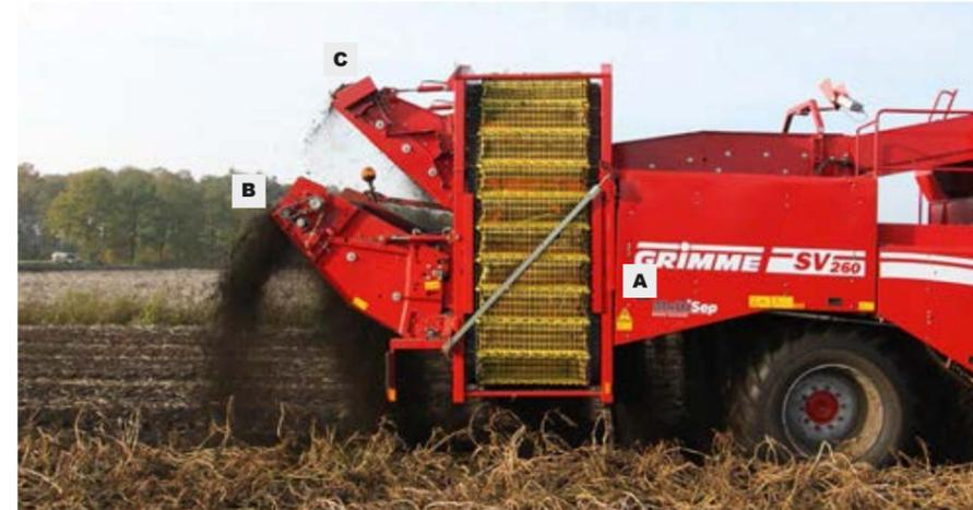
Für noch mehr Trennleistung kann die MultiSep-Variante (A) kombiniert werden mit Feinkrautelevator unten (B) und Feinkrautelevator oben (C).
