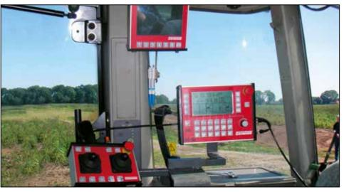
Tout à vue : un système vidéo avec écran et caméra – jusqu'à 8 caméras possibles – ordre d'images à programmer librement sur l'écran (option)
