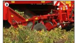
Une bonne prise : réglez l'inclinaison des socs pour un arrachage idéal en utilisant le soc à deux parties pour des sols lourds ou le soc à trois parties pour des sols légers à moyens (2). Pour une sécurité supplémentaire, profitez aussi de la protection «pierre» des socs d'arrachage en option.
