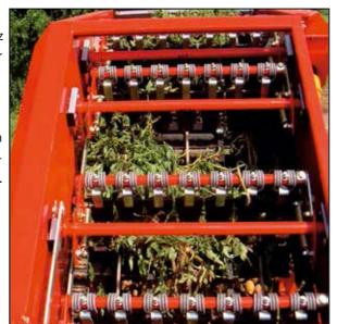
Un maximum de soin pour le produit : La chaîne effaneuse à grande maille est équipée avec des ameneurs caoutchoutés doux en PU (selon vos souhaits: pas de 210 mm ou 280 mm).
