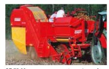
SE 75-30 : pour moyennes et grandes surfaces, construction compacte et rationnelle, trémie fond mouvant, capacité de 3000 / 3300 kg
