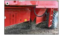
Bac à cailloux avec trappe de vidange (option) d'une capacité de 700 kg (6). Le remplissage s'effectue par des trappes montées pour un accès facile. La vidange s'effectue mécaniquement à l'aide d'un pédalier sous la bande de triage. Une vidange hydraulique à partir de la cabine ou de la bande de triage est disponible en option.
