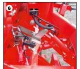
Un bon compromis: profitez du centrage sur buttes automatique en option (4). Grace à deux capteurs montés sur le châssis du diabolo, le vérin de timon centre automatiquement le diabolo sur la butte.
