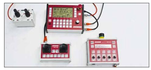
Grâce au GBT 2100 et aux pupitre de commande associés, atteignez toutes les fonctions d'un seul coup de main de la cabine ou de la table de triage. Par exemple: réglage en continu des 6 peignes de retenues (3 en haut et 3 en bas) sur la chaîne à grandes mailles, réglage sans à-coups de la profondeur d'arrachage, réglage individuel en continu des 1er et 2ème tapis à tétines, de la hauteur du double rouleau émotteur ou les programmations de fonctionnement comme début ou fin de champ.
