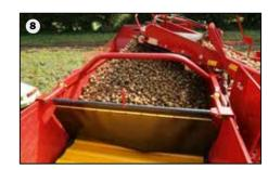
Des hauteurs de chutes minimales sont assurées au remplissage du fond mouvant (7/8) par l'action simple de lever ou de baisser le col de cygne. Profitez aussi de l'automatisme du col de cygne (option): pour garder une hauteur de chute minime et constante, votre col de cygne se relève peu à peu automatiquement en détectant le niveau de produit dans la trémie.
