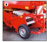
pour une prise minimale du sol : se grandes roues de support à voie compose de roues de support, d'un réglage de profondeur hydraulique et d'une vitesse réglable du convoyeur à brosses en nylon.
