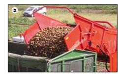
Vidange rapide et soigneuse: trémie aux grandes dimensions se lèvant aisément à une hauteur de déversement de 4,20 m grâce à un bouton. Le système de levage permet de conserver une position latérale de déversement quasi constante, quelque soit la hauteur de déchargement (1).
