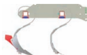
Geveerde aanaarders nr. 5 met bladveertand nr. 5 (niet in hoogte verstelbaar)
