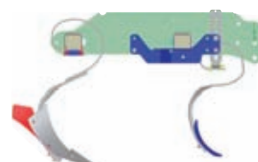
Geveerde aanaarder nr. 5 met woelertand nr. 2 (in hoogte verstelbaar)
