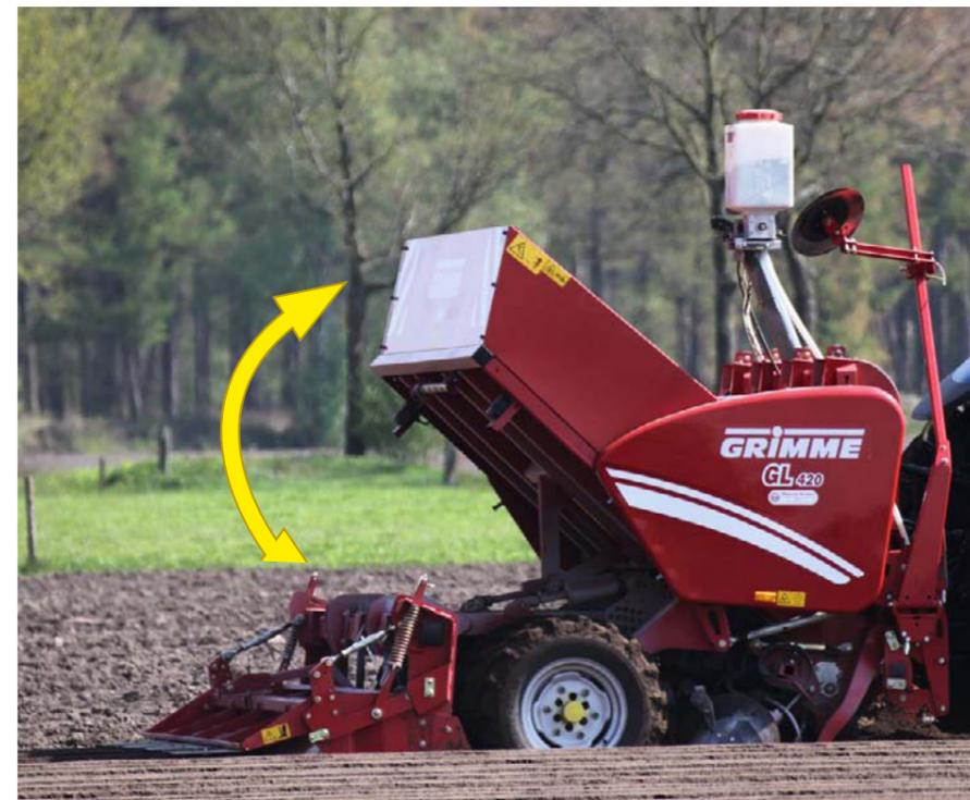
Fahrerentlastung an langen Arbeitstagen: Ein Sensor vor dem Legeelement erfasst den Füllstand vor den Bechern. Ein kurzfristiges Anheben und wieder Absenken des Bunkers sichert eine optimale und schonende Befüllung des Schöpfraumes (Option).
