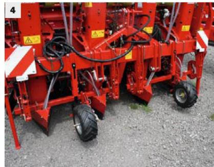
Ein Tastsensor (1) steuert über Hydraulikzylinder (2) das Heben und Senken des Zinkenbalkens (3) und des Dammbormbleches (4).
