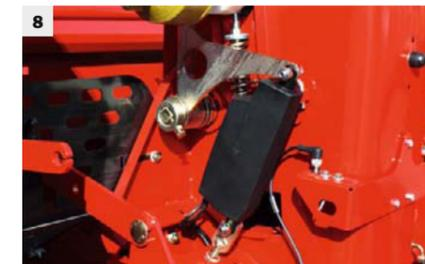
Für das Anlegen von Fahrgassen oder auf keilförmigen Schlägen können die Legeelemente mechanisch (7) oder komfortabel elektromechanisch (8) vom Schlepper aus einzeln abgeschaltet werden.
