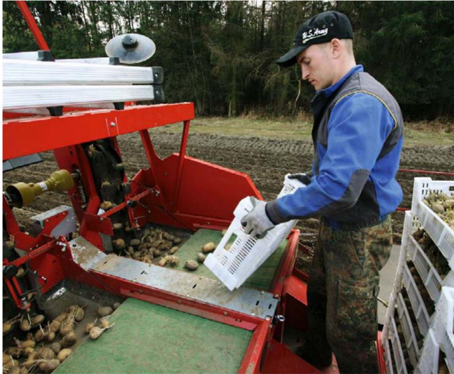
Rollboden-Modul mit komfortabler Standfläche für eine ergonomische Befüllung des Rollbodens
