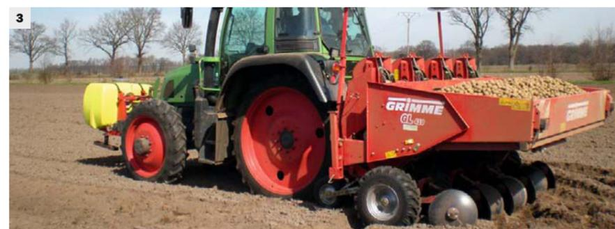
Hydraulischer Kippbunker flach 1.200 kg (3)
