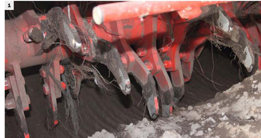
Mit dem GR 300 wird die volle Breite bearbeitet (1). Die 110 Zinken sind in Spiralforn angeordnet, dadurch wird ein sehr ruhiger Lauf gewährleistet.
