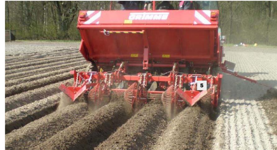
Optional kann der Dammaufbau auch mit einer Gitterrolle (5) erfolgen, die durch die Schaffung einer Krümelstruktur den Sauerstoff- und Feuchteaustausch im Damm fördert.
