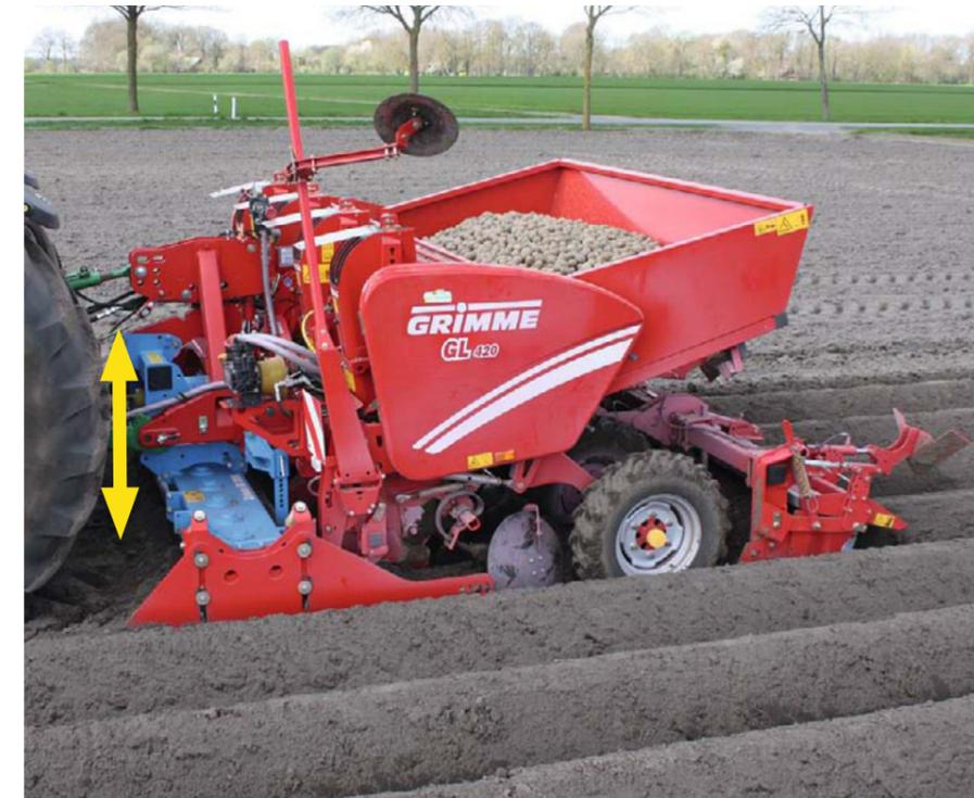
Mehrere Anbauarten, ein Ziel – variable Tiefenführung der Bodenbearbeitung: Der Anbaubock der Legemaschine trägt das Gerät zur Bodenbearbeitung, hier ein Lemken Zirkon 10. Dieses kann hydraulisch um 180 mm in der Tiefe verstellt werden.
