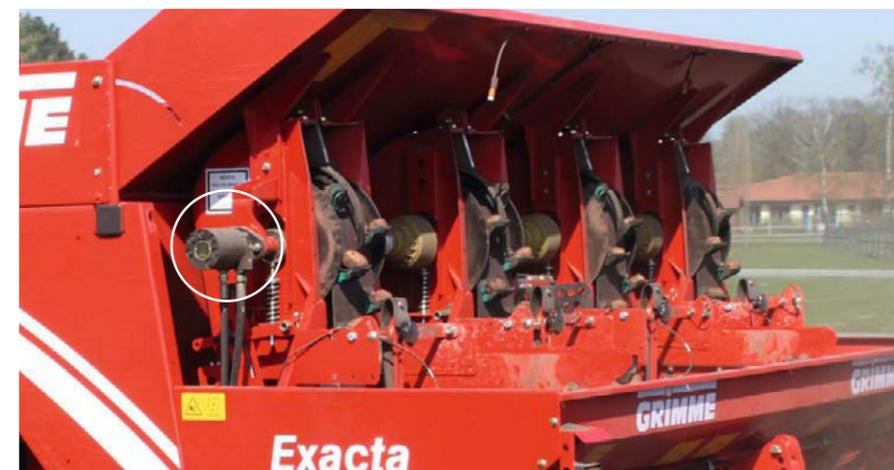
Die Legeelemente werden über einen hydraulischen Antrieb angesteuert (stufenloser Legeabstand).
