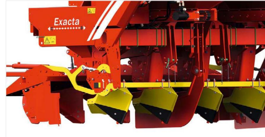
Die Tiefenführung der Furchenzieher erfolgt über eine mechanische Verbindung zwischen Dammformblech und den gezogenen Furchenziehern im Parallelogramm.
