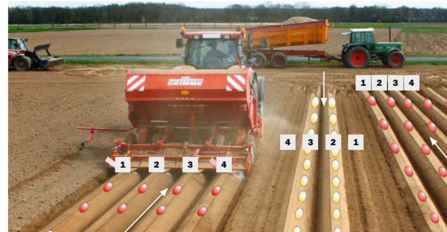
Bei Ausstattung der Maschine mit einem gemeinsamen, hydraulischen Antrieb der Legeelemente erfolgt die Hydraulikversorgung vom Schlepper aus und erlaubt stufenlos verstellbare Legeabstände.
