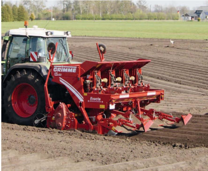
Die Exacta ist serienmäßig mit hydraulischem Antrieb, Bedienterminal GBT 850 und Störmelder ausgestattet.
