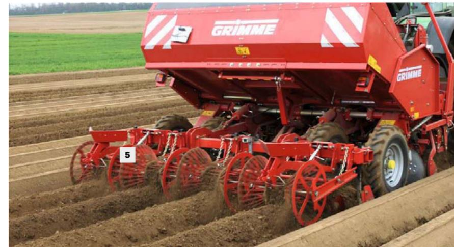
Optional kann der Dammaufbau auch bei der GL 420 mit einer Gitterrolle (5) erfolgen.
