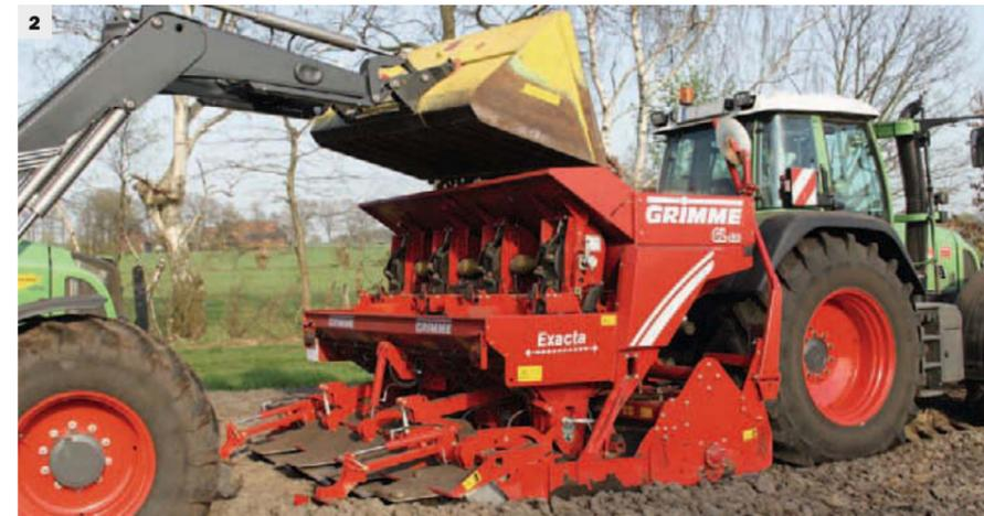
Durch die Einwurfsche (2) kann sehr schonend mit Frontlader oder Befüllband befüllt werden.
