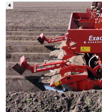
Die Menge im Element (3) wird sehr genau über Sensoren gesteuert. Nach Ablage der Knolle erfolgt sofort der Dammaufbau über das Dammbormblech (4).
