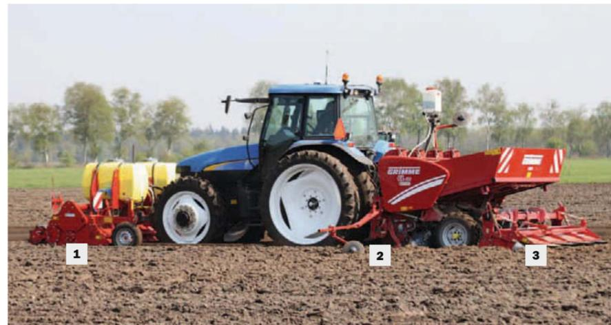
In den Rota Tiller GR 300 sind Bodenleitbleche eingebaut. Damit wird die Erde vor den Rädern weggeräumt und es erfolgt keine Überfahrt des späteren Wachstumsbereichs der Knolle.
