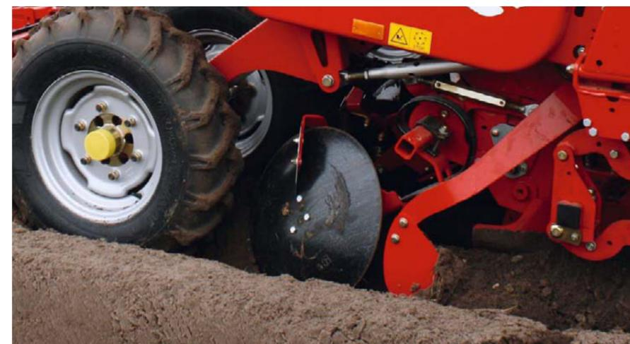
Die Zudeckscheiben direkt hinter den Furchenziehern bauen den Damm bereits fast vollständig auf. Das Dammbormblech muss also keine zusätzliche Erde heranholen.
