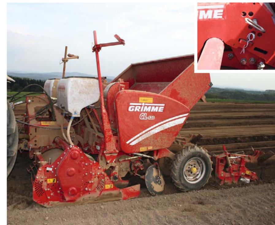
GL 420 in Kombination mit dem Grimme Rota Tiller GR 300 im Heckanbau. Die Tiefenführung des GR 300 wird einfach über ein Lochbild in acht Stufen verstellt. Beide Anbauvarianten der Bodenbearbeitung stellen sicher, dass die Ablagetiefe der Kartoffel unabhängig von der Bearbeitungstiefe des Bodens einstellbar ist.
