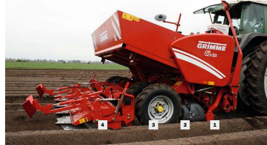
Der kleine, aber feine Unterschied: Der gezogene Furchenzieher (1) umschließt das Legeelement und wird über das Tastrad geführt. Bereits vor den Rädern (3) erfolgt der Dammaufbau durch die 510 mm großen Zudeckscheiben (2). Der finale Dammaufbau erfolgt hier mit einem Dammbormblech (4).
