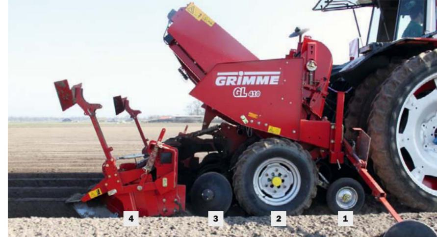
Der gezogene Furchenzieher (1) umschließt das Legeelement und wird über das Tastrad geführt. Nach den Rädern (2) erfolgt der Dammaufbau durch 460 mm Zudeckscheiben (3), gefolgt vom Dammformblech (4) für die finale Form.
