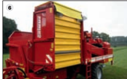
En blød landing takket være en faldtragt (ekstraudstyr) (5): Til en skånsom aflæsning på vogn. Efter behov: Mekanisk opklappelig faldtragt (ekstraudstyr) (6)
