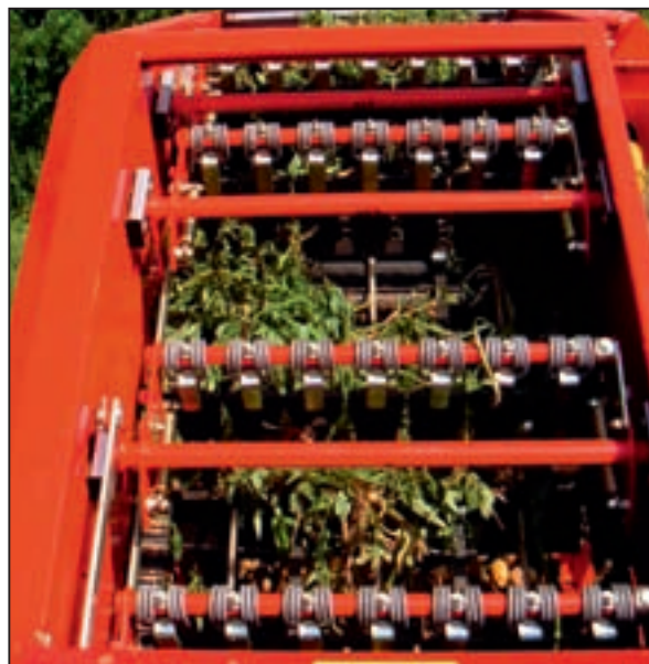
Optimal produktskånsomhed: vidmasket topkæde med bløde PVC-medbringere (afstand hhv. 210 mm, 280 mm)
