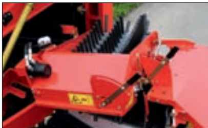
Pigbåndets hastighed indstilles hydraulisk og trinløst
