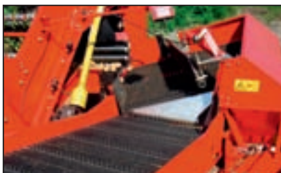
Type NB: Træk for pigbånd og afstrygervalse via traktorens hydraulik
