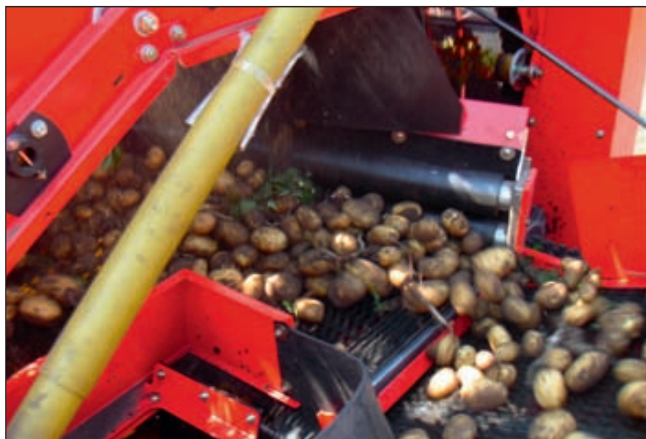
Trinløs indstillelig via digitalteknik (ekstraudstyr): 6 Tilbageholdskamme på topkæden (hhv. 3 foroven og 3 forneden)
