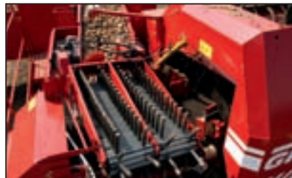
UB 900, Dobbelt pigbånd (ekstraustyr): En forbedring af fraskilning på jord med mange knolde
