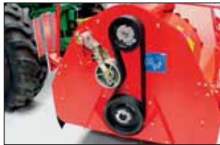
Minimalt underhåll: den automatiska kilremspänningen (KS 75-2, KSA 75-2 och KS 75-4)
