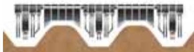
Med bättre avstånd: den optimala placeringen av slagorna i förhållande till kamstrukturen
