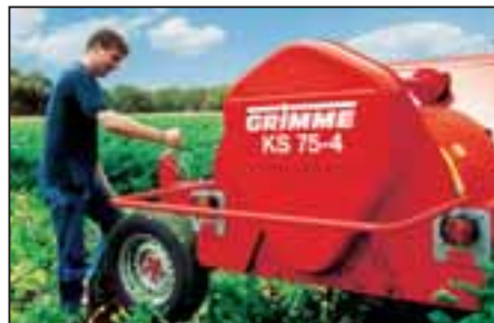
Så här krossar du ännu enklare och bättre: stödhjulen fungerar som en steglös höjdställning...
