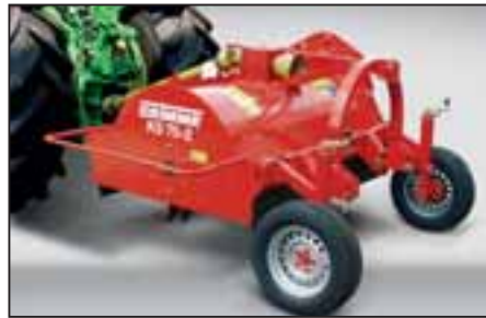
Perfekt löst: ändringen från front- till bakmontering, genom en enkel förflyttning av kraftöverföringsaxeln
