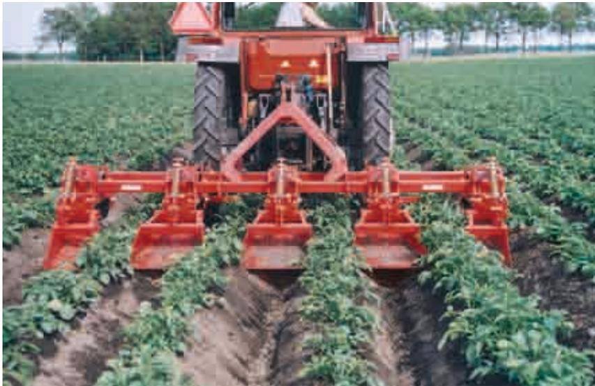
高效率：叶片式弹簧犁铧和独立的中耕单元（高度可调）起到松散土壤的作用
