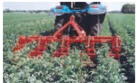
适合苗后中耕：即使秧苗已经很高，仍可使用该中耕机作业
