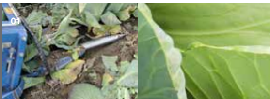
01 Hydraulisch rotierende Torpedos sichern den gleichmäßigen Einzug vom Kohl.
