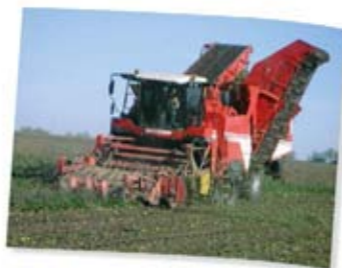
Плотный сорняк в России: для комбинации ботвоудалителя с боковой лентой выброса и роторного дообрезчика не составляет никаких проблем.
