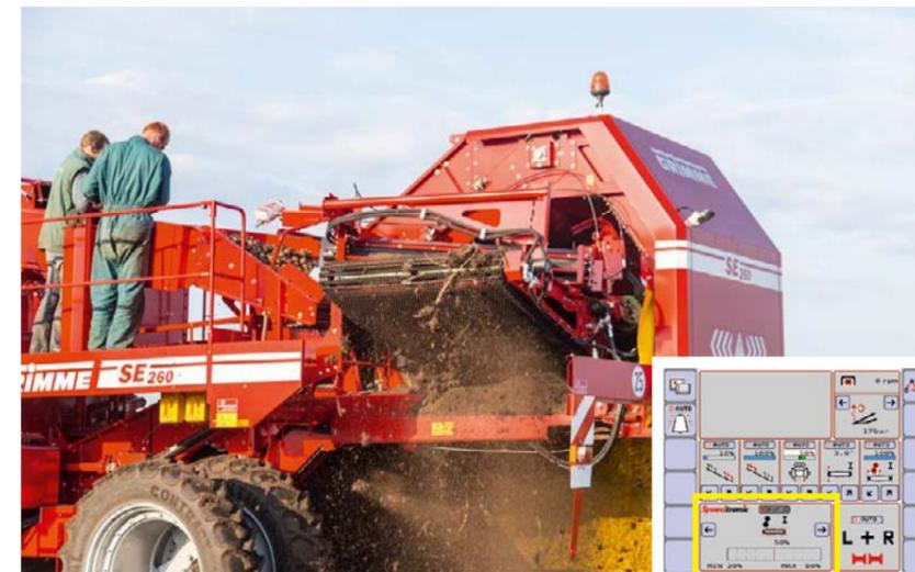
转速自动匹配系统是用于1级和2级分离单元以及拣选平台的与负载相关的全自动速度控制。
