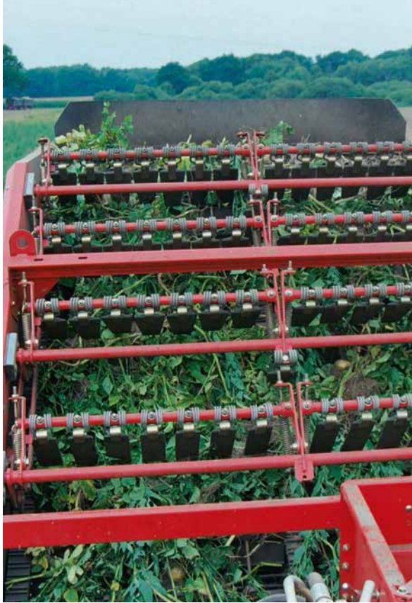
Optimum ürün koruması: PU alıcılarla birlikte kaba ot bandı (mesafeler isteğe bağlı olarak 200 mm, 280 mm)
