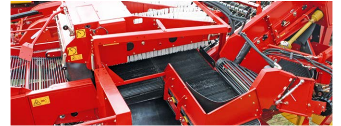
Tip SB: Çok taşlı topraklarda yenilikçi kinetik taş ayırma cihazı sayesinde en iyi ayırma performansları
