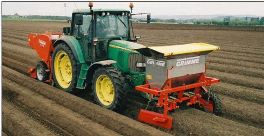
Travail préliminaire solide: la fonction de l'outil de pré-buttagage frontal est de former les buttes devant le tracteur, de façon à comprimer le moins de terre possible.
