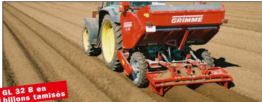
Idéale sur tous les sols : la cape formeuse avec option de pression réglable hydrauliquement (1) peut être réglée aisément à partir du tracteur.
