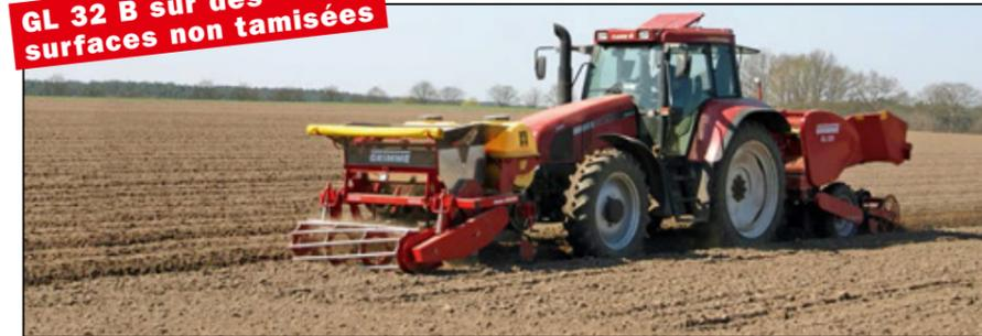
Fertiliser, planter, butter : avec la GL 32 B, tout est accompli en un seul passage, même sur des surfaces non tamisées. Avec la complémentarité de la GL 32 B compacte et du distributeur d'engrais frontal optionnel, des manœuvres rapides pour tourner sont possibles. De cette façon, vous ne perdez pas de temps et vous profitez d'un résultat efficace.
