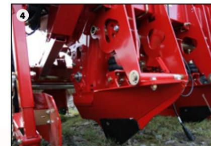
Formation d'une butte solide et poreuse en terres légères : les corps sillonneurs remontent la terre qui est rappuyée en surface par les diabolos cage. Leur construction ajourée permet de maintenir la porosité de la butte (3).
