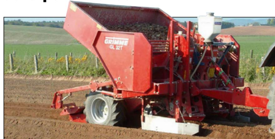
Construite sur base de la robuste GL 34 T, la GL 32 T est une déclinaison à 2 rangs de cette planteuse fût trainée qui fut l'inspiration de la toute la gamme. Grâce au châssis extrêmement stable et compact, la trémie peut contenir 2500 kg de plants de pommes de terre.
