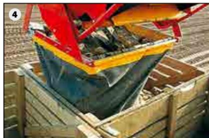
Le succès se récolte... en douceur : l'élévateur de chargement plonge profondément dans le véhicule de transport et transfère la récolte en douceur sur le tas, grâce aux compartiments bâchés de 1,20 m de large.
