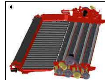
Doublez le succès : combinez le MultiSep (3) ou le séparateur à rouleaux (4) à un MultiSep supplémentaire. Les séparateurs pouvant être ajustés individuellement au niveau de leur puissance de nettoyage, il vous est ainsi possible de réagir de façon optimale aux fluctuations des conditions.
