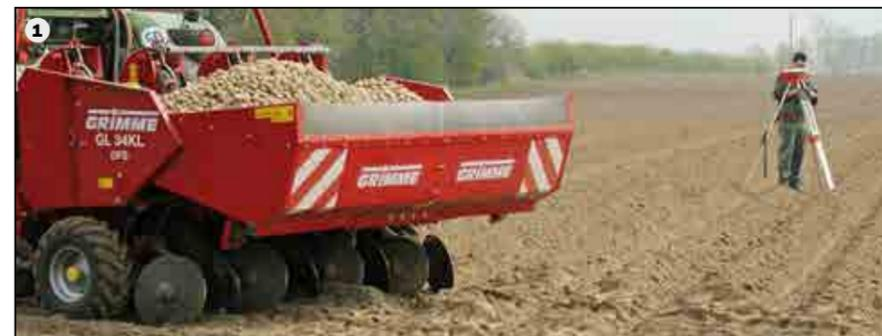
La pratique démontre que c'est possible : le fait de planter 4 rangs à l'aide de la technique GPS (1) garantit un écart précis et régulier entre les billons, et donc la possibilité de toujours récolter 3 rangs.
