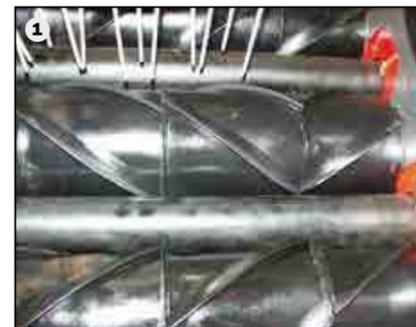
Pour une utilisation universelle : les rouleaux segmentés à 4 lèvres montés en version standard dans le MultiSep.
