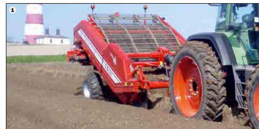
CS 240 (1) : séparer les pierres et briser les mottes : c'est ainsi que l'on ameublit le billon de façon homogène et que l'on crée des conditions de croissance optimales pour les pommes de terre et autres légumes – ceci, avec une toute nouvelle dimension.
