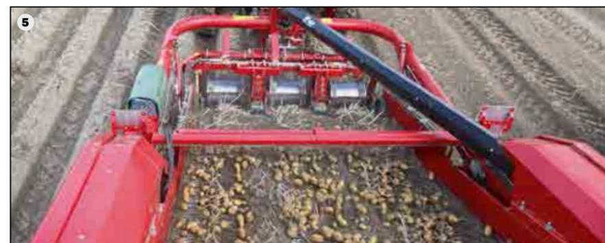
Une toute nouvelle dimension : arrachage sur 3 rangs avec la GT 300 (5). La technique éprouvée du flux axial, allié à la faible inclinaison des chaînes de tamisage, évite le brassage du produit pour un maximum de rendement sur cette machine.
