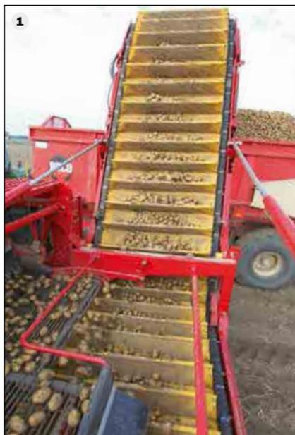
Un transfert en douceur. Un maximum de flexibilité. Avec un débit de 160 tonnes/h ! – Voici les caractéristiques de l'élévateur de chargement de la GT 300. Ses parties latérales actives, sa longueur et sa mobilité vous assurent un transfert en douceur des tubercules vers la remorque.
