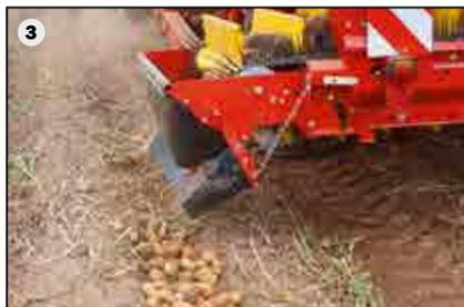
En douceur jusqu'à la caisse : la goulotte de remplissage de caisses (4) optionnelle permet de transporter les pommes de terre en douceur jusqu'au fond de la caisse.
