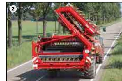
Stable sur champ – compacte sur route. Malgré ses dimensions impressionnantes (1), la machine peut rouler sans problème sur toutes les routes avec une largeur de 3,3 m (2). La roue droite est pour cela rentrée et sortie par coulisseau hydraulique.
