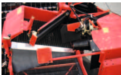
Тип NB с 3-м игольчатым транспортером и 3-м очищающим вальцом для улучшения производительности на почвах с небольшим содержанием примесей
