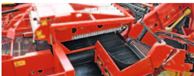
Тип SB: наилучшим образом проявляет себя на каменистых почвах благодаря инновационному кинетическому камнеотделительному устройству
