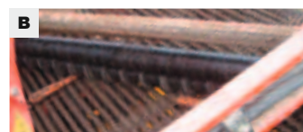
Сдвоенный очищающий валец (А), опционально спиральный валец (В) для увеличения сепарации
