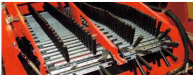
Тип UB: наилучшие результаты на почвах с большим содержанием комков и небольшим содержанием камней
