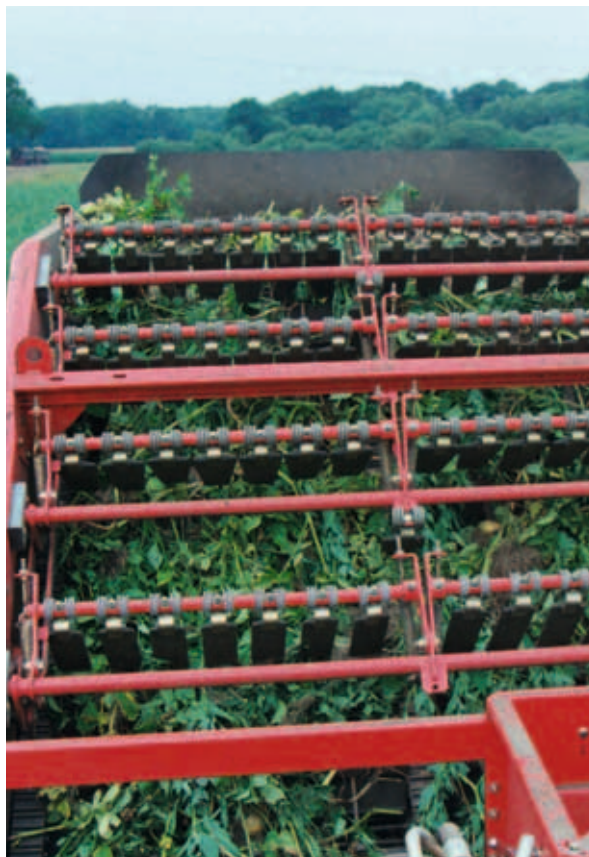
Щадящая обработка продукта: транспортер для отделения крупной ботвы с мягкими скребками из полиуретана (расстояние на выбор 200 мм, 280 мм)
