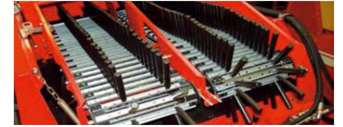
Type UB : les meilleurs résultats de séparation sur sols riches en mottes et peu caillouteux
