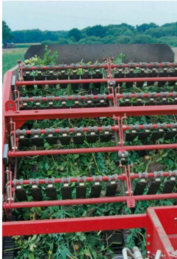
Un maximum de soin pour le produit : la chaîne effaneuse grandes mailles équipée avec des ameneurs en PU doux
