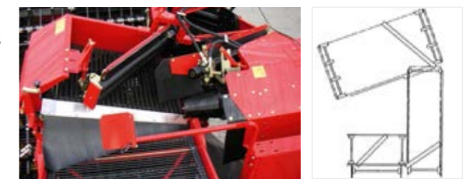
Type NB avec 3 ème tapis à tétines et 3 ème rouleau émotteur pour augmenter les performances sur les terrains pauvres en déchets
