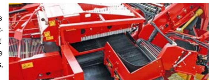
Type SB : les meilleurs résultats de séparation sur des sols riches en pierres grâce au système novateur de séparation cinétique des pierres
