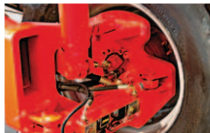
Hydrostatische wielaandrijving (optie) Ontspannen rooien – ook onder natte omstandigheden: met de hydrostatische wielaandrijving.
