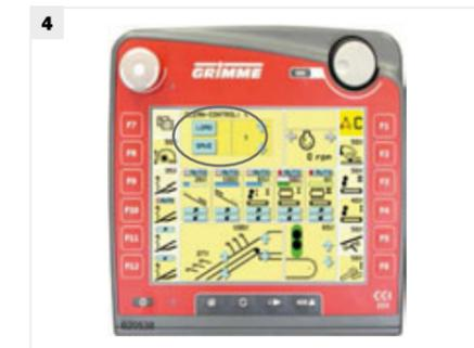
Weltweit einmalig: das von Grimme mitentwickelte herstellerübergreifende Bedienkonzept CCI 200 (3) für ISOBUS-kompatible Landmaschinen (Option).
