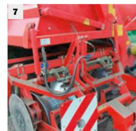
Gut aufgenommen: Nutzen Sie das 2-Blatt-Schar für schwere Böden sowie das 3-Blatt-Schar für mittlere und leichte Böden. Schützen Sie die Spatenschar mit der optionalen Steinsicherung (5).
