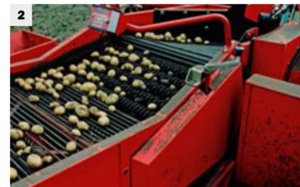
Bei Einsatz des Trenngerätes UB oder SB trennen 5 hydraulisch verstellbare Sortierwalzen zuverlässig Untergrößen (1).
