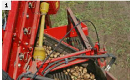
Die hydraulische Seitenverstellung
