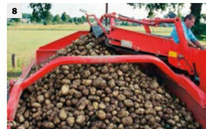
Minimale Fallstufen bei der Befüllung des Rollbodenbunkers (7/8) durch hydraulisches Anheben und Senken des Vorsatzbandes. Profitieren Sie von der Vorsatzbandautomatik (Option): Steigt der Schüttkegel im Bunker hebt sich das Vorsatzband automatisch in kleinen Schritten an, um eine gleichbleibend niedrige Fallstufe zu erreichen.
