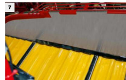
Für alle, die Großes vorhaben: Der groß dimensionierte Bunker lässt sich auf Knopfdruck bequem zum Überladen hydraulisch auf eine maximale Auslaufhöhe von 4,20 m ausheben. Durch die Lenkeraufhängung werden nahezu gleichbleibende Überladeweiten bei unterschiedlichen Aushubhöhen erzielt. Die wellenförmige Bodenkontur des weichen Bunkertuchs sorgt für kurze Entladezeiten. Zwei Geschwindigkeitsstufen stehen für eine schnelle Restentleerung bereit.
