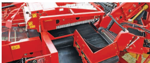
Type SB: bedste sorteringsresultater på jord med mange sten takket være det banebrydende, kinetiske stenpigbånd.
