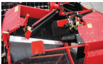
Type NB med 3. pigbånd og 3. afstrygervalse – for større kapacitet på jord med få knolde og sten.
