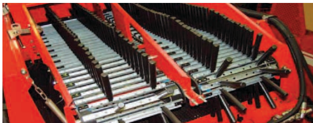
Type UB: de bedste fraskilningsresultater på knoldet jord med få sten.
