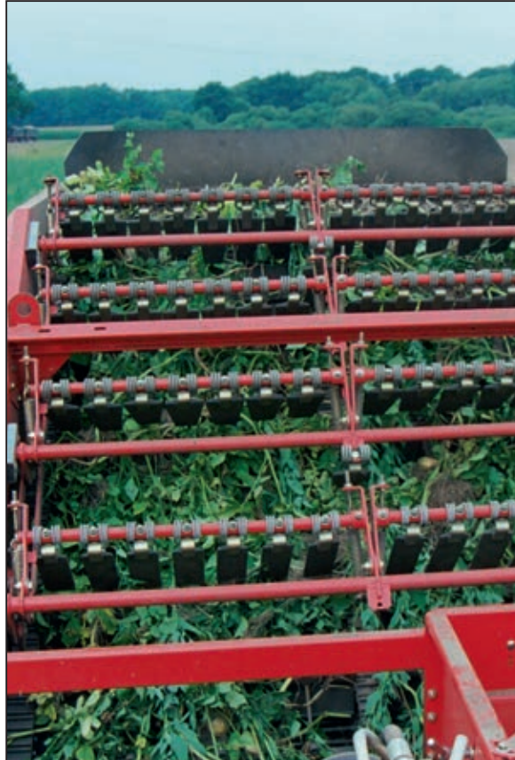
Optimalt skonsam produkthantering: Grovblastmatta med mjuka PU-medbringare (avstånd vardera 200 mm, 280 mm)
