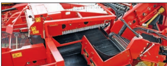
Typ SB: bästa frånskiljningsresultat på stenrika jordar tack vare det innovativa stenfrånskiljningsaggregatet
