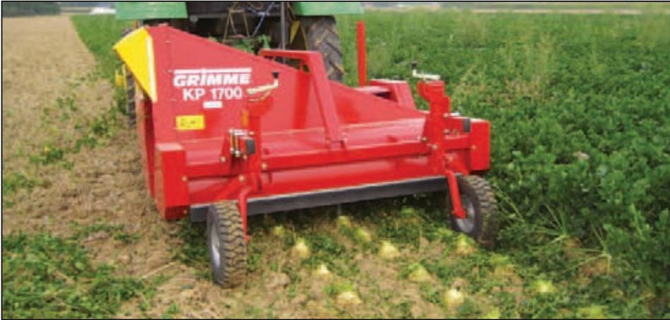
Tiefenführung die keine Wünsche offen lässt. Zwei Laufräder vorn, verstellbar über eine Spindel; optional zwei zusätzliche Laufräder hinten mit Spindel oder komfortable, hydraulisch verstellbare Laufräder hinten.
