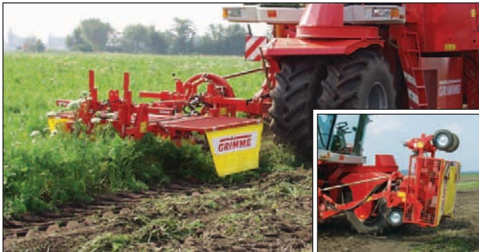
*... oder im Heck am Schlepper anbauen – das Kraut wird immer reihenunabhängig, sauber abgeschnitten und sicher zur Seite befördert.*
