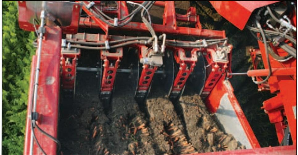
Klutenreißer über dem Siebband unterstützen die sichere und schonende Absiebung von Beimengen (hier am Beispiel Rote Bete).
