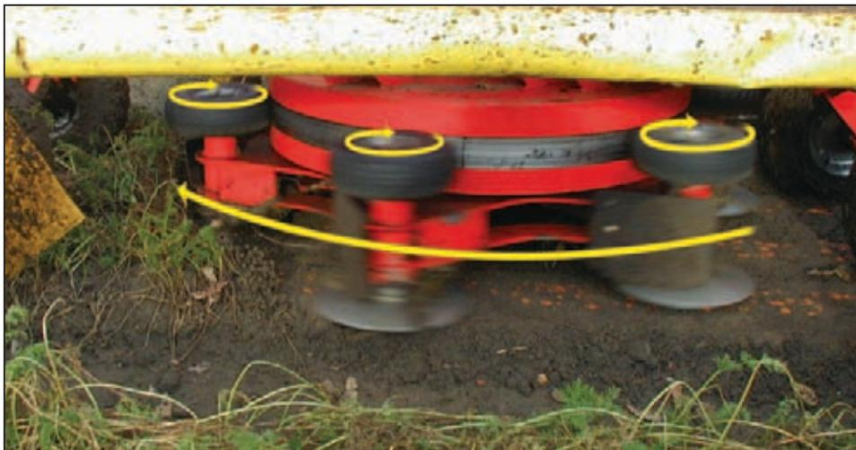
Aktiver, gezogener Schnitt. Der Rotor ist mit mechanisch angetriebenen Schneidescheiben ausgerüstet für ausgezeichnetes, leistungsstarkes, sauberes Köpfen. Bei Bedarf kann die Drehrichtung geändert werden.
