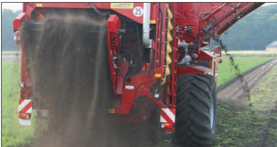
Eine feine Sache: Feinkraut-elevatoren gibt es für die GT 170 (wenn kein Verlesetisch verwendet wird) und den VARITRON. Sie sind besonders bei feinem Möhrenkraut eine gute Hilfe für eine sorgfältige Krauttrennung.
