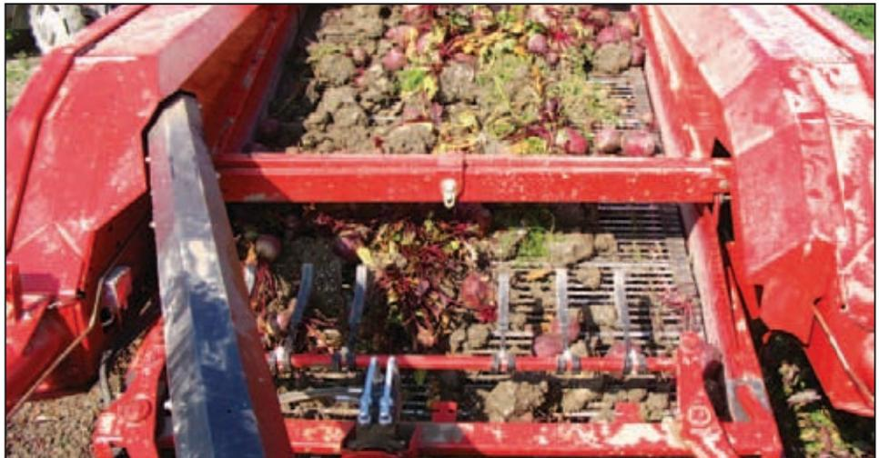
Zur Unterstützung der Absiebung werden vor allem Rotorklopfer (1) eingesetzt, die entweder manuell oder komfortabel hydraulisch verstellt werden können.
