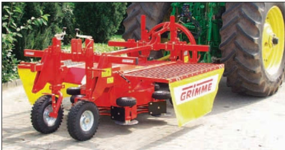
*Tiefenführung: Der Rotor wird in einem robusten Rahmen mit 4 spindelverstellbaren Laufrädern genau über das Beet geführt.*
