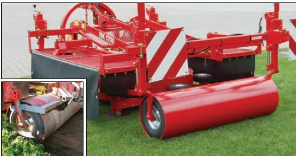
Breit aufgestellt: Nutzen Sie unser optionales Walzenfahrwerk zur gleichmäßigen Tiefenführung im Beet, wenn die Spurtiefe ungleichmäßig wird.
