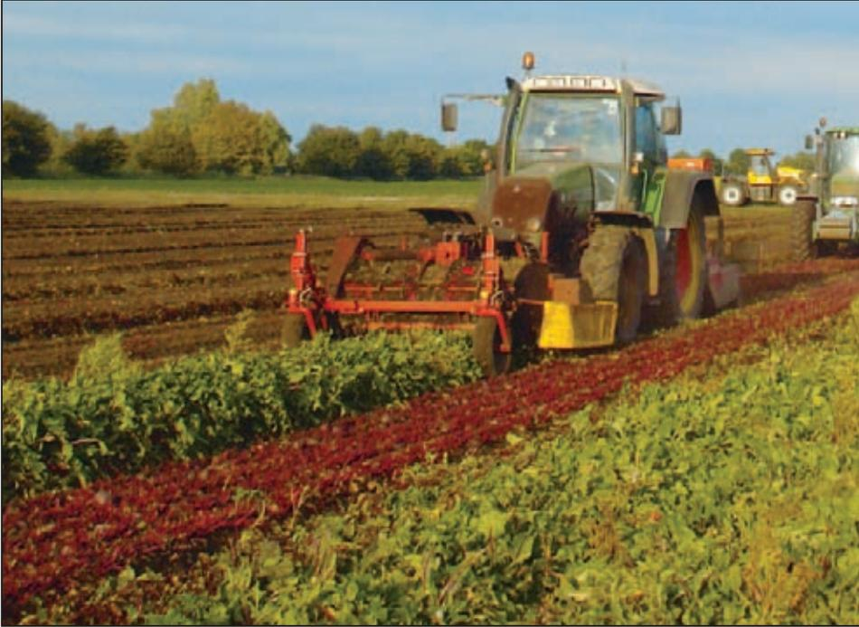
Und wenn die Sicht nach vorn mal beschränkt ist, so wie hier in Rote Bete, dann wählen Sie die Variante im Heckanbau. In beiden Fällen lassen sich Arbeitsgänge kombinieren: z. B. mit Krautputzer ...
