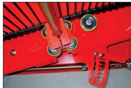
Механический роторный встряхиватель (гидравлический встряхиватель устанавливается опционально)
