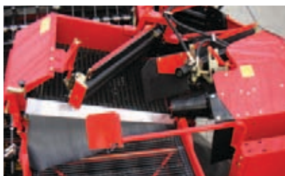
Tipo NB con 3.ª cinta de erizos y 3.º rodillo rastrillador: todavía más productividad en suelos con poco desperdicio
