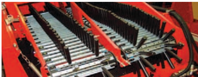
Tipo UB: la mejor separación en suelos con muchos terrones y poca piedra
