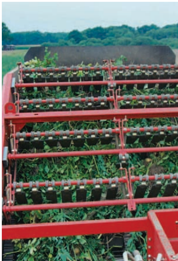
Tratamiento cuidadoso del producto: cinta de broza (paso 200 mm o 280 mm) extrae la hierba y transporta
