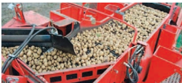
Tipo NB: la mejor separación en suelos con poco desperdicio
