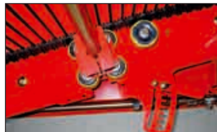
Mekanisk rotorskak (hydraulisk kan levereras som tillval)
