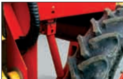
Lutningsautomatik (tillval) Alltid jämvikt: lutningsautomatiken för skördning i sluttingar erbjuds som tillval.
