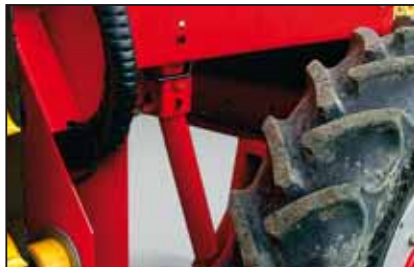
Neigungsautomatik (Option) Immer im Gleichgewicht: Die Neigungsautomatik für das Roden an Hanglagen ist optional erhältlich.
