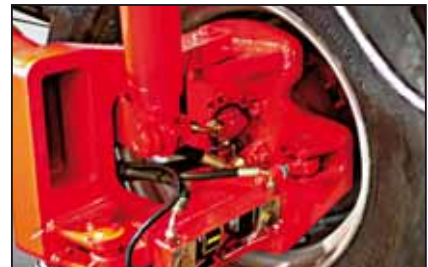
Hydrostatischer Radantrieb (Option) Entspannt roden – auch unter widrigsten Bedingungen: mit dem hydrostatischen Radantrieb.
