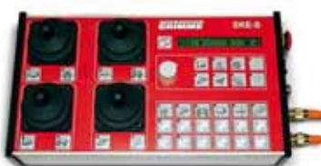
SKE-Standard-Bedienterminal Serienmäßig alles im Griff: Über das abnehmbare SKE-Bedienterminal können sämtliche Maschinenfunktionen vom Schlepper aus gesteuert werden.
