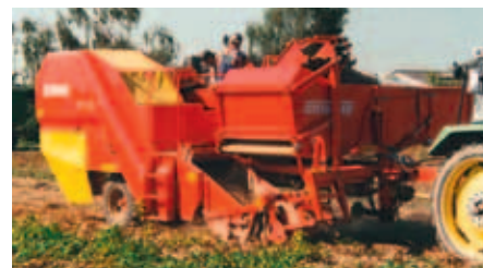
SE 75-20: na małe i średniej wielkości powierzchnie uprawowe, zwarta (niska) konstrukcja, zbiornik z ruchomą podłogą na 2.000 wzgl. 2.300 kg
