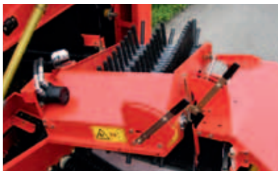
Prędkość taśmy palcowej reguluje się w płynny sposób hydraulicznie.
