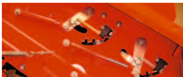
Opcjonalnie płynnie ustawianie za pomocą techniki cyfrowej 6 grzebieni zatrzymujących (po 3 u góry i 3 u dołu) na taśmie łącinowej
