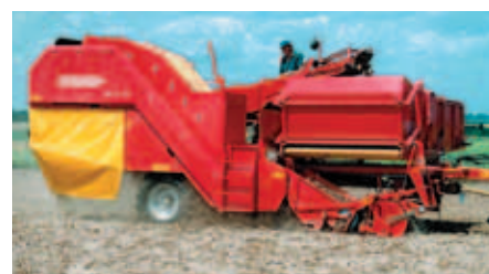
SE 75-40: na duże powierzchnie uprawowe, przejrzysta konstrukcja, zbiornik z ruchomą podłogą na 4.000 wzgl. 4.300 kg
