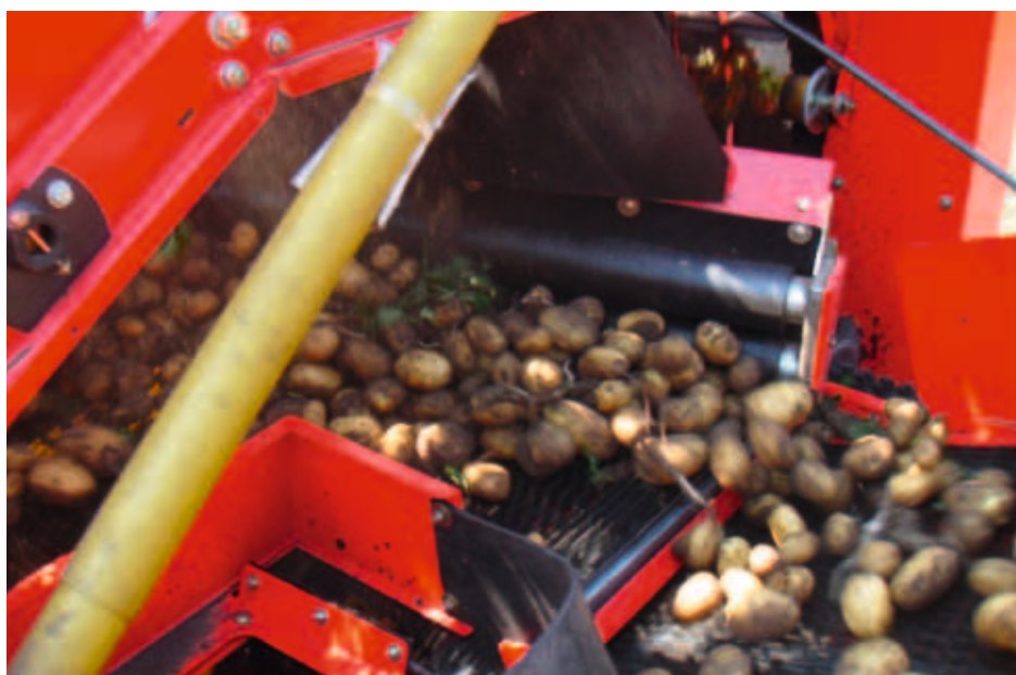
Opcjonalnie płynnie ustawianie za pomocą techniki cyfrowej 6 grzebieni zatrzymujących (po 3 u góry i 3 u dołu) na taśmie łącinowej
