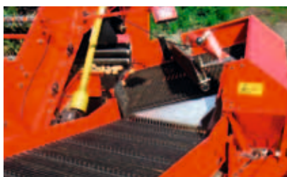
Typ NB: Napęd taśmy igłowej i wałka od hydr. ciągnika
