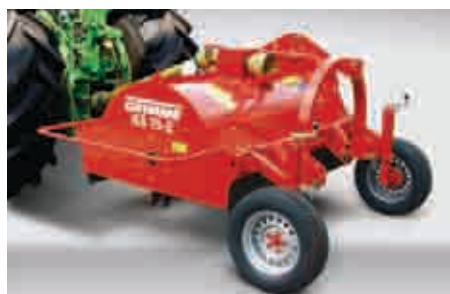
两种拖拉机悬挂方式：前悬挂与后前悬挂可自由转换
